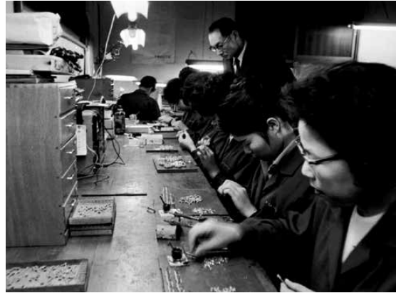
Ligne de fabrication de cellules phono stéréo
