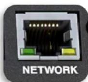
RJ45, Fast Ethernet (nur für Netzwerk-Steuerdaten)
