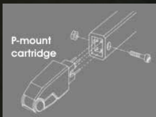
Montage eines P-Mount-Tonabnehmers an einem P-Mount-Tonarm (Schraube und Mutter bei allen Modellen im Lieferumfang)
