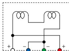
Cableado interno de la AT-MONO3/LP
