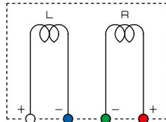
Cableado interno de la AT33MONO
