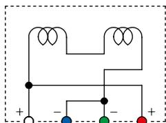
Cableado interno de la AT-MONO3/SP
