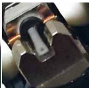
Las **AT33MONO**, **AT-MONO3/LP** y **AT-MONO3/SP** son verdaderas cápsulas mono debido a la configuración horizontal de las bobinas.
