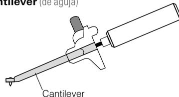
La aguja es la suma de 3 componentes: punta, cantilever y suspensión. El cantilever es un pequeño brazo suspendido (sólido o de tubo) que sostiene la punta de diamante en un extremo y transfiere las vibraciones al otro extremo donde se encuentran los imanes (en cápsulas de imán móvil) o las bobinas (en cápsulas de bobina móvil). Se utilizan diferentes materiales para hacer un cantilever: aluminio, zafiro, berilio, boro, etc.; y cuanto más ligero y rígido es mejor.
