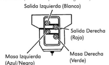
Para instalar una cápsula fonográfica, conecte los 4 cables del portacápsula a los terminales correctos en la parte posterior de la cápsula.
