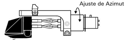
Es el ángulo entre la superficie del disco y el eje vertical de la cápsula. Este ángulo debe ser de 90° para asegurar un óptimo balance de canales.
