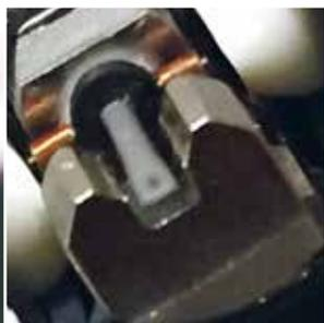
Las **AT33MONO**, **AT-MONO3/LP** y **AT-MONO3/SP** son verdaderas cápsulas mono debido a la configuración horizontal de las bobinas. La cápsula solo genera señal eléctrica con movimiento horizontal debido a la configuración horizontal de la bobina.
