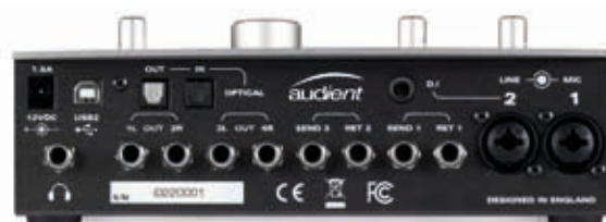
Interface audio 10 entrées / 14 sorties et contrôleur de monitoring
